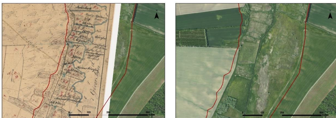
2.3. Figur 3. Tv. Et eksempel på de oprindelige slyngninger af Halkær Å, som det ses på Original 1-kortene. Th. Samme kortudsnit på et ortofoto fra 2020. Den kanaliserede Halkær Å ses centralt i undersøgelsesområdet.
